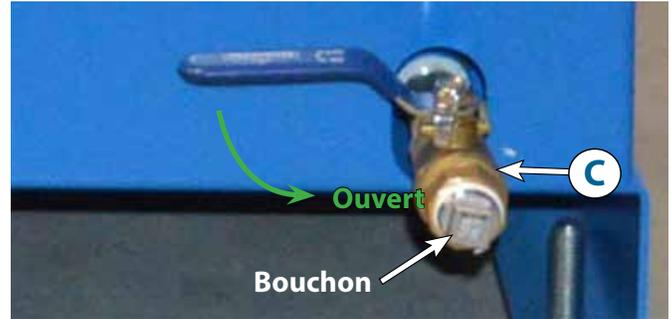
2. Retirez le bouchon et vidangez l'huile du réservoir du refroidisseur d'huile en ouvrant la valve à bille [C] après avoir placé un bac de récupération d'huile en dessous ou raccordez-le à une pompe.
