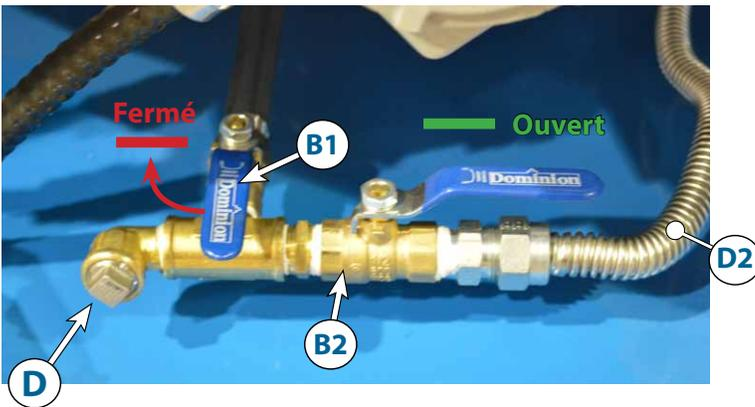
3. Fermez la valve à bille [B1], ouvrez la valve à bille [B2], dévissez le bouchon [D], connectez-le à une pompe et vidangez l'huile de la bouilloire.
